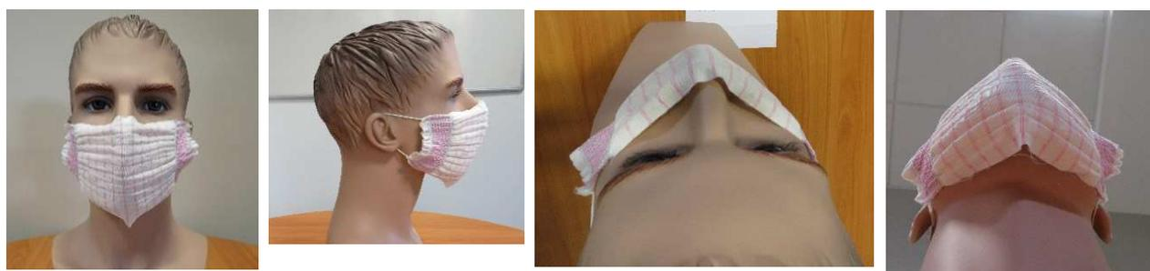
**Conclusion de la DGA :** Le matériau de la société Les tissages de Charlieu (masques lavés) présente des performances en filtration et en perméabilité à l'air compatibles pour un usage de type masque chirurgical.
